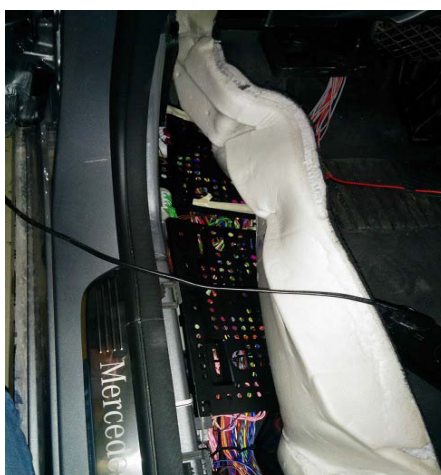
1. Plastikabdeckung entfernen und Fußboden nach oben klappen
